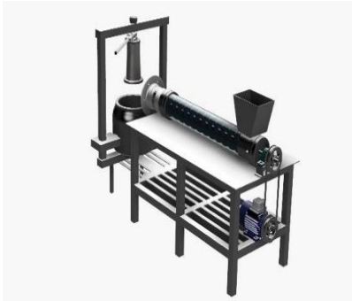
Gambar 1. Desain Teknologi Pemasta dan Pengempa Kakao
