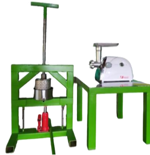
Gambar 2. Modifikasi Teknologi Pemasta dan Pengempa Kakao
